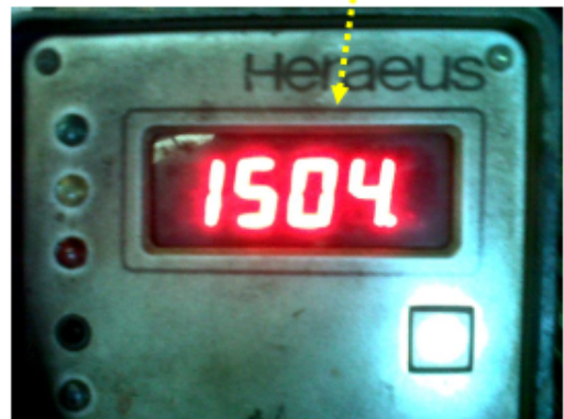
Gambar 8. Pengukuran suhu cairan pada tungku induksi
